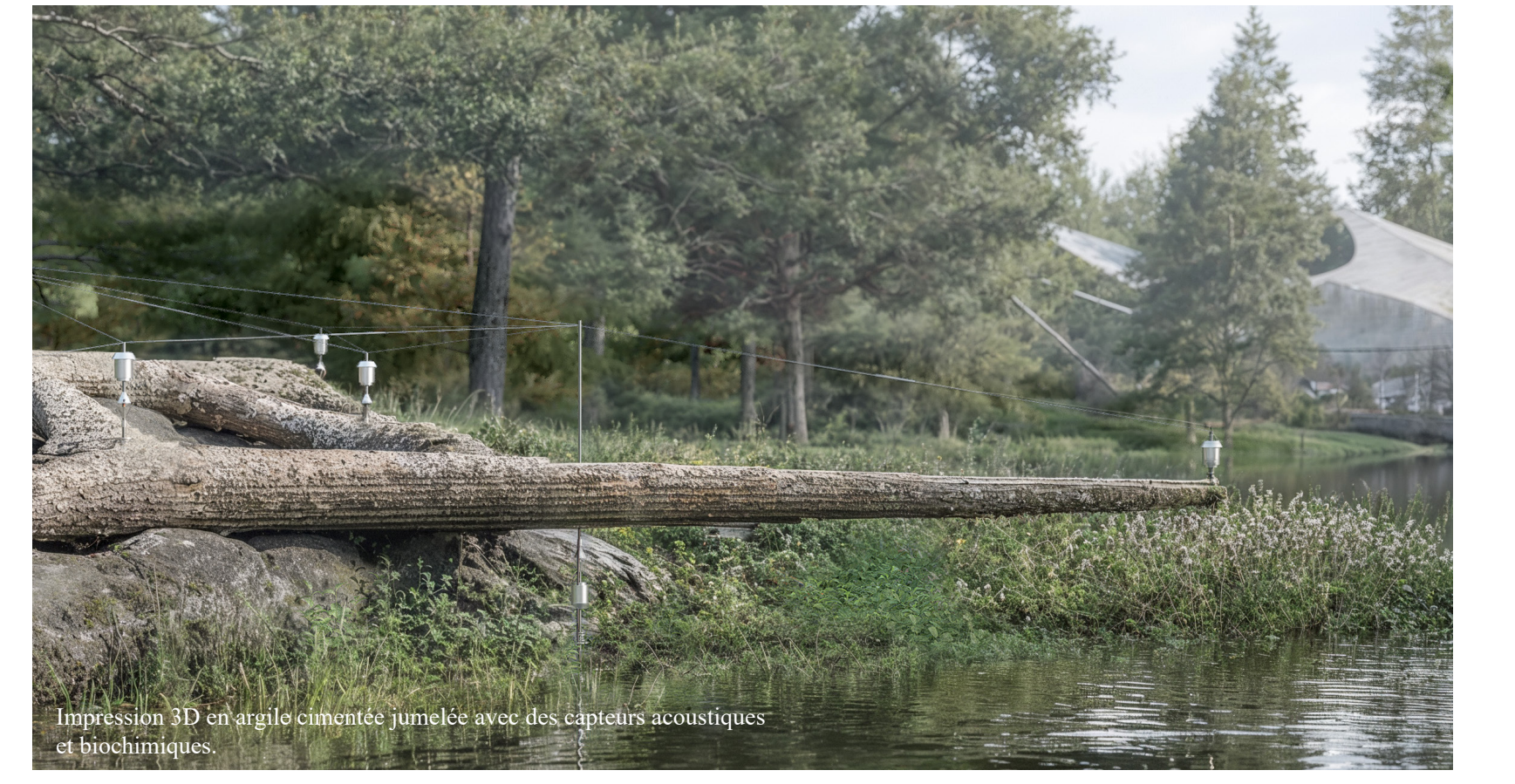
Impression 3D en argile cimentée, capable d'accueillir capteurs scientifiques et bioturbateurs.
